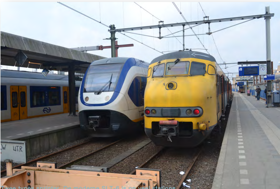
Twee types sprinter. De moderne SLT-6 is op veel stations voor rolstoelers goed toegankelijk zonder assistentie Auteur: Alfenaar
